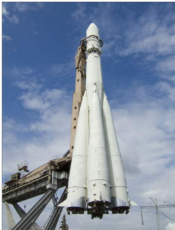
Figura 2. Racheta R7. Înălțimea rachetei este de 34 m. https://en.wikipedia.org/wiki/Vostok_(rocket_family)
